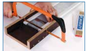
Zuschneiden der Profile auf die benötigte Länge.
